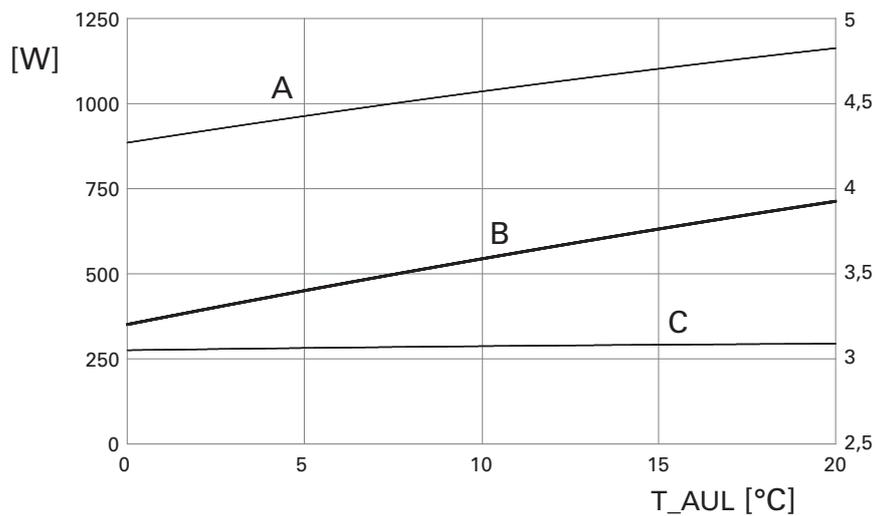
A ..... Thermische Gesamtleistung der Wärmepumpe für Raumheizung und Brauchwassererwärmung [W]
